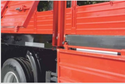
Puertas laterales de apertura pendular y volcable con herrajes fabricados en micro-fusión.
